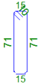
2 x 2Ø8 pos. 12 L=192 orizz. metà inferiore
